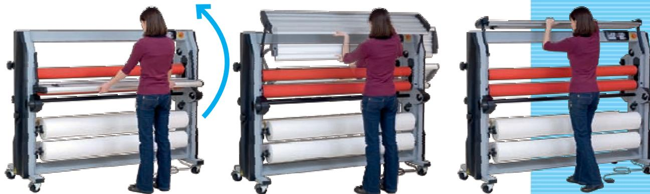
Подающий стол ламинатора поднимается вверх, предоставляя полный и безопасный доступ к машине при загрузке материала. В верхней позиции, двигатель заблокирован, предохраняя оператора от травм во время операции.
